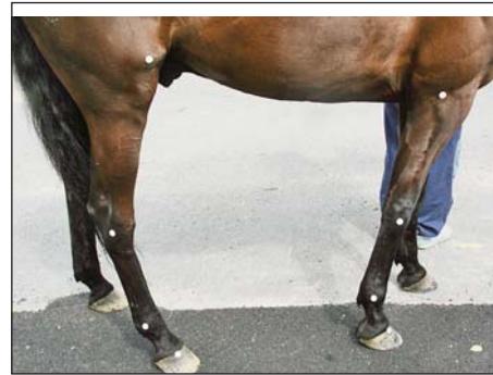
Norsk Hovslagersenter bruker møbelknotter som referansepunkter når det filmes med høyhastighetskamera fra siden. Etterpå kan de måle akselerasjon, hurtighet, distanse og vinkler ved hjelp av møbelknottene.
